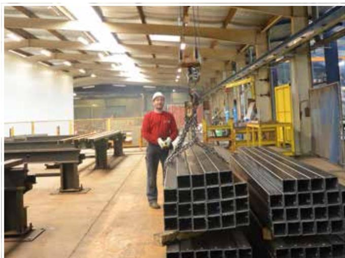
Levage de charges avec un pont roulant
