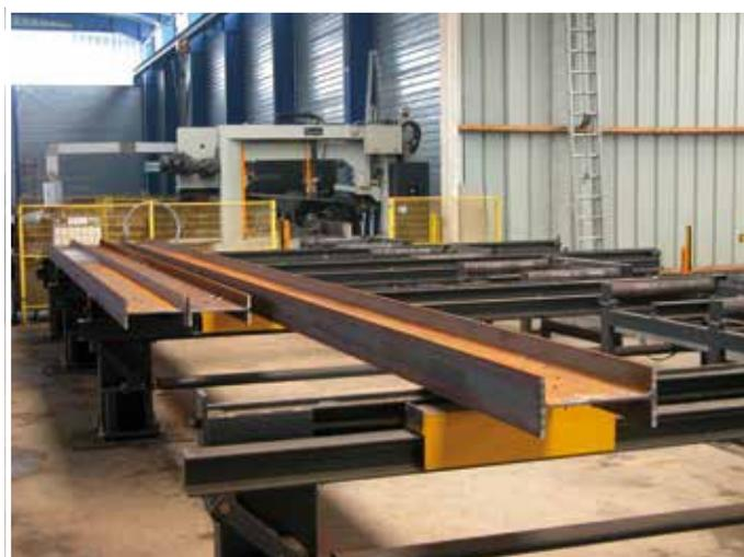
Banc de perçage et découpe à commande numérique
